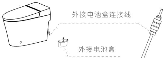
请将陶瓷背部外接电池盒连接线与外接电池盒连接,即可在停电时进行冲水。
