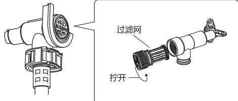
用一字螺丝刀逆时针旋开过滤器，取出过滤网；
