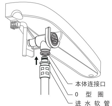
■ 将金属卡扣插入进水软管和本体连接口的连接部，注意要插到底。（直到听到“啪”的一声）
