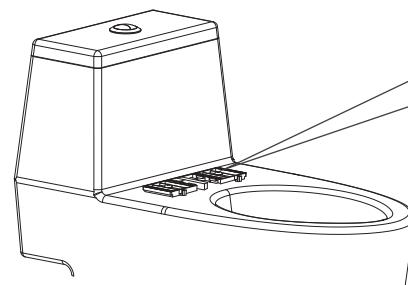
**3** 将固定螺丝穿入垫圈，将安装托板和整机安装板固定在陶瓷体上。
