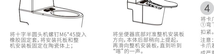
将十字半圆头机螺钉M6\*45旋入
