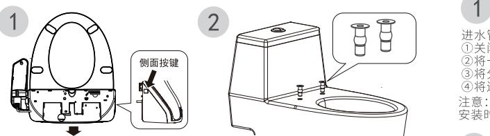
向下轻拉整机安装板
