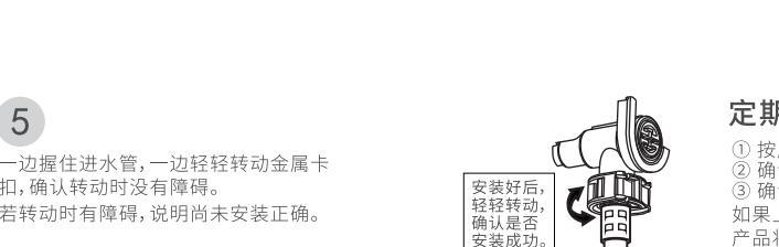
一边握住进水管，一边轻轻转动金属卡扣，确认转动时没有障碍。
