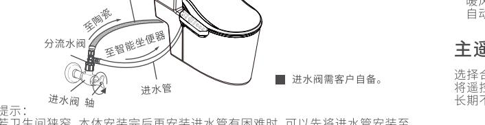
提示：若卫生间狭窄，本体安装完后再安装进水管有困难时，可以先将进水管安装至本体，再将本体安装至陶瓷。
