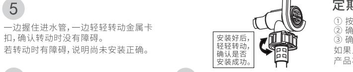
一边握住进水管，一边轻轻转动金属卡扣，确认转动时没有障碍。若转动时有障碍，说明尚未安装正确。
