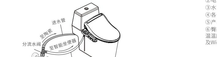
确认金属卡扣是否已切实固定。轻轻拉动进水管，确认进水管不会脱离本体。
