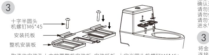
将十字半圆头机螺钉从橡胶固定套中旋出，再将橡胶固定套装入陶瓷体安装孔内；
