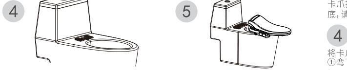
十字半圆头机螺钉M6\*45旋入橡胶固定套，将安装托板和整机安装板固定在陶瓷体上；
